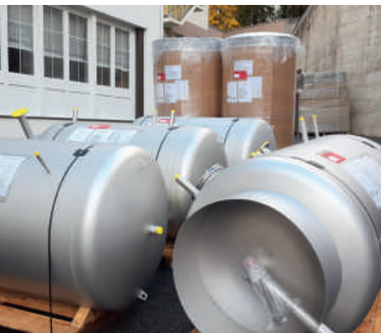
Lieferung von Edelstahl-Warmwasserspeichern, 4 Stück à 1800 Liter und 2 Stück Wärmerückgewinnungsspeicher (hinten) für das Hotel Sunstar, Davos.
