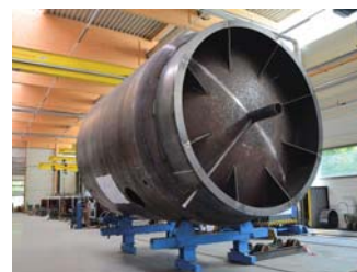
Fabrikation eines Speichers mit Durchmesser 4,0 m.
