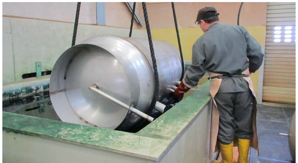
Hohe Qualität bei Edelstahlspeichern dank Beizen im Vollbad.
