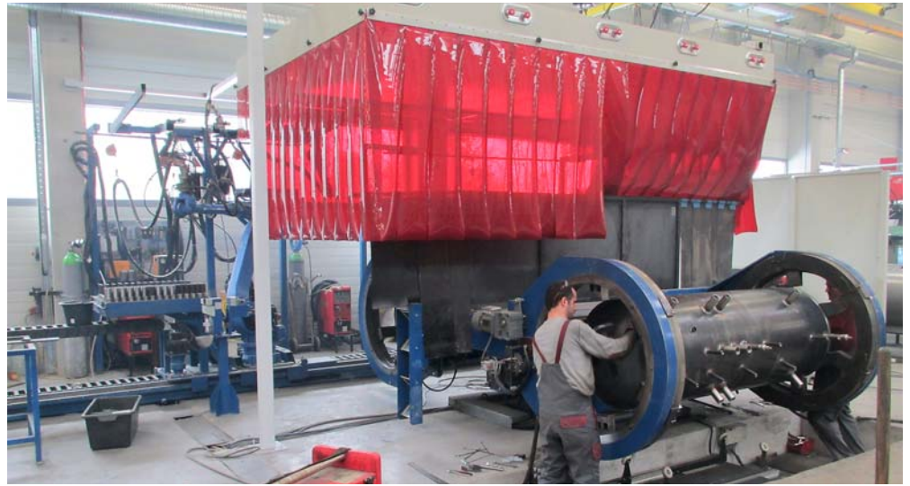
Schweißanlage für Kombispeicher.
